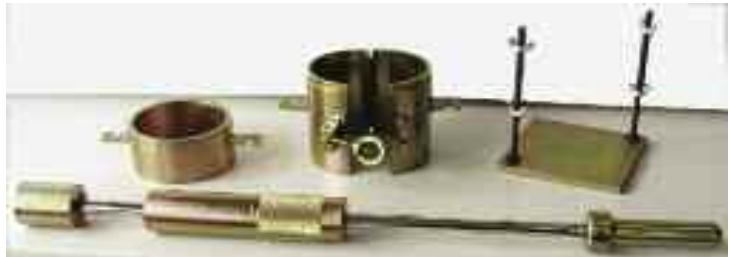
EQUIPO PROCTOR NORMAL CON MOLDE ABIERTO 20.0115 Y MAZA ARMY 2,5 Kg.
