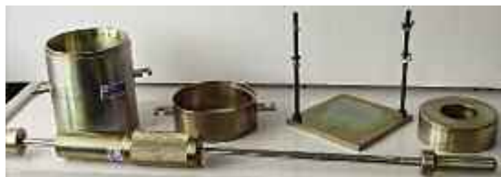
EQUIPO P. M. CON MOLDE CERRADO 20.0141 Y MAZA ARMY 4,5 Kg.
