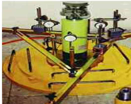
Ensayo de carga en placa: Lectura con célula de carga.
