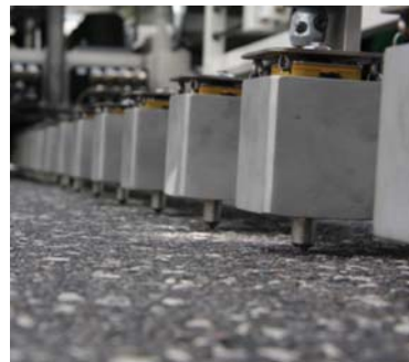
Los geófonos son fácilmente accesibles y sencillos de reemplazar
