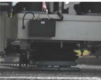
La placa de carga de cuatro secciones permite el pleno contacto con la superficie y una medición de alta precisión.
